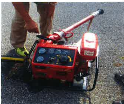
非常用エンジンポンプ
