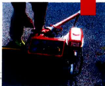
非常用エンジンポンプ
