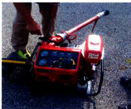
非常用エンジンポンプ
