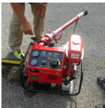
非常用エンジンポンプ
