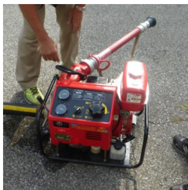
非常用エンジンポンプ
