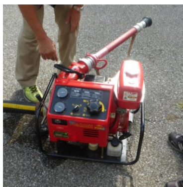
非常用エンジンポンプ
