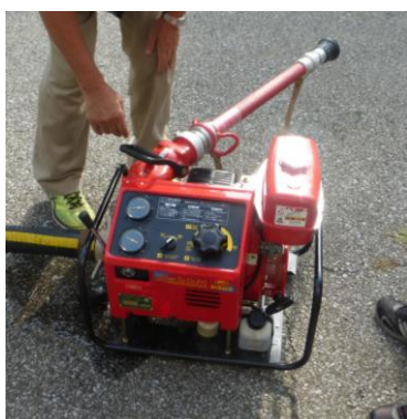
非常用エンジンポンプ
